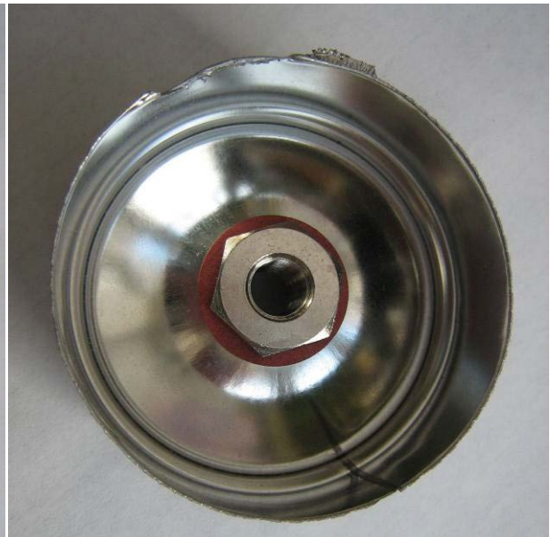
Innere Ansicht auf die Schraubbefestigung am Boden des Behälters
