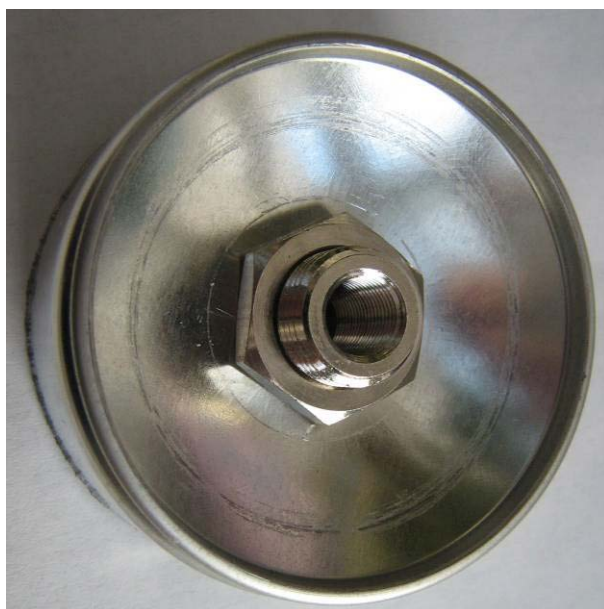
Vue de l'extérieur du raccord monté sur le fond du réipient
