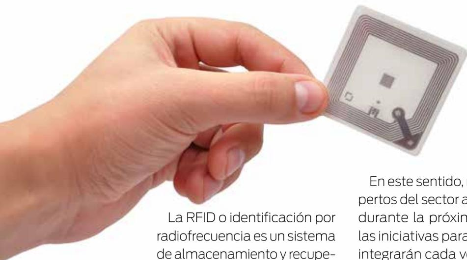
La RFID o identificación por radiofrecuencia es un sistema de almacenamiento y recuperación de datos remotos que usa dispositivos denominados etiquetas, tarjetas o transpondedores RFID, cuyo propósito fundamental es la transmisión de la identidad de un objeto mediante ondas de radio.
